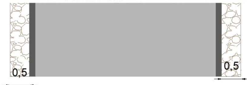
**Ilustración 2** Detalle de protección en concreto ciclópeo.
