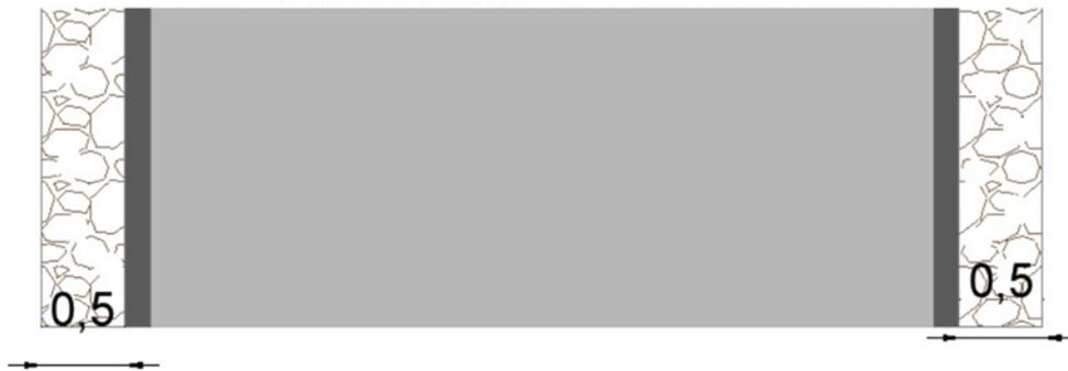
**Ilustración 32** Detalle de protección e concreto ciclópeo
