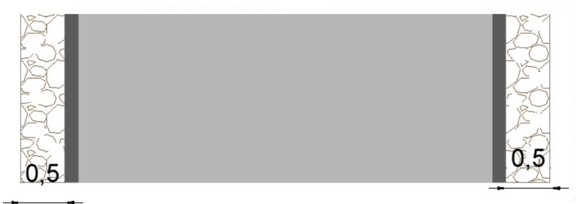
**Ilustración 18** Detalle de protección en concreto ciclópeo.
