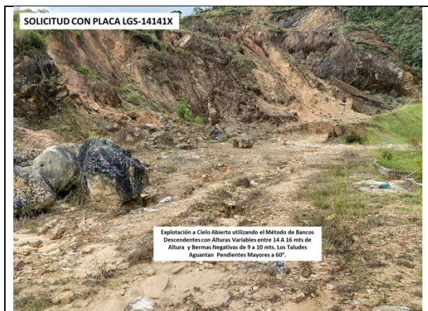
Foto 1: Frente de Explotación a Cielo Abierto por medio de Bancos Descendentes y Bermas Negativas
